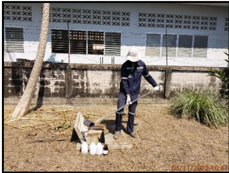
บ่อกักน้ำทิ้งที่ออกจากถังตกตะกอนก่อนระบายออกสู่ภายนอกโครงการ
