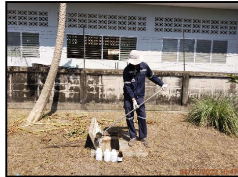
บ่อกักน้ำทิ้งที่ออกจากถังตกตะกอนก่อนระบายออกสู่ภายนอกโครงการ
